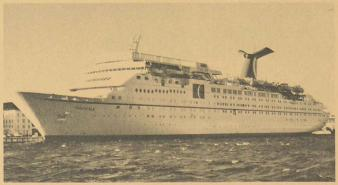
« Tropicale » (30 000 tjb) des Carnival Cruise Lines, équipé de 2 moteurs diesel Sulzer a crosse, à marche lente, développant une puissance totale de 19 560 kW (26 600 ch).
