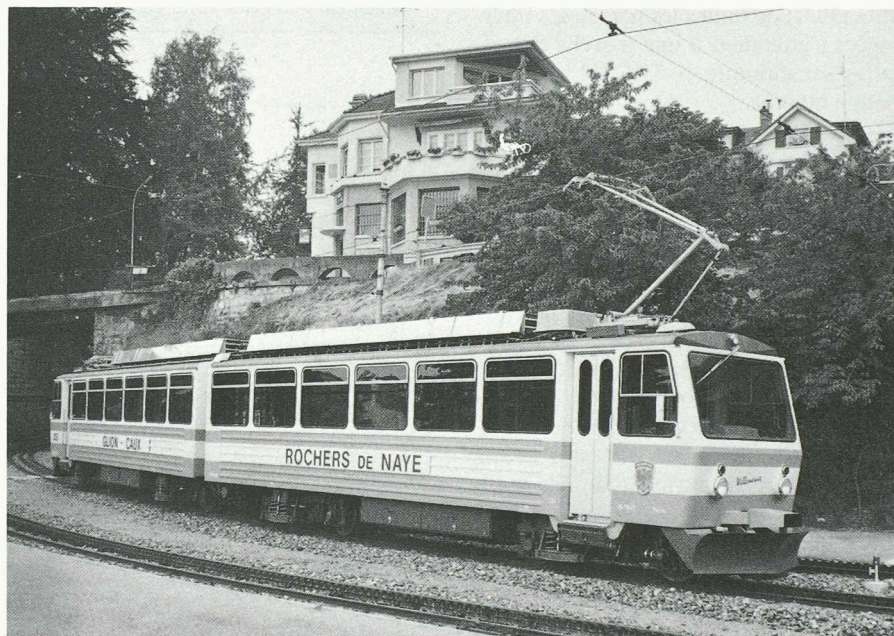
Automotrice électrique double du chemin de fer à crémaillère Montreux-Glion-Rochers de Naye. (Photo SLM)
