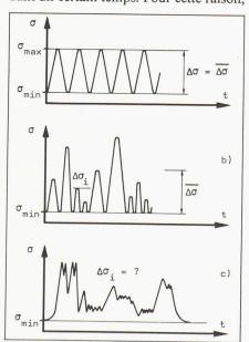
Fig. 6. — Comparaison de diagrammes de contraintes en fonction du temps. a) Evolution sinusoïdale à amplitude constante des contraintes au cours du temps. b) Suite aléatoire d'amplitudes variables. c) Contraintes réelles.
