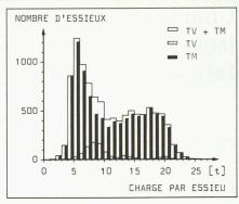
Fig. 4. — Histogramme des charges par essieu des trains classés d'après leur fonction (TV: trains voyageurs, TM: trains marchandises).
