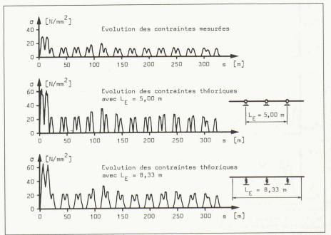
Fig. 12. — Comparaison des évolutions des contraintes mesurées et théoriques dans l'entretoise au cours du passage du train nº 73.
