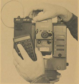
L'interface de données DIF 41 permet de transmettre les valeurs de mesure fournies par le télémètre électro-optique DM 502 ou le théodolité électronique E 1 vers une calculatrice HP-41 C/CV. La calculatrice HP programmée traite les valeurs et transmet les résultats.
