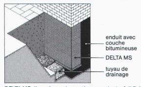
DELTA MS: l'enveloppe à excroissances tout a fait fiable; à l'extérieur: utilisation optimum de la cave; à l'intérieur: pièces d'habitation, salle de jeux, de bricolage, buanderie, sauna, séchoir, débarras, etc... grâce au DELTA MS votre sous-sol est au sec.
