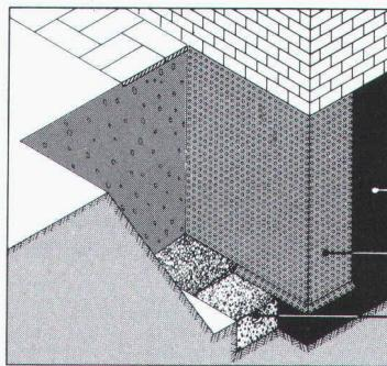
enduit avec couche bitumineuse
