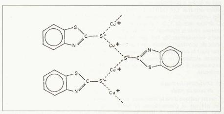
Fig. 14. — Structure proposée pour Cu<sup>I</sup> (MBT).
