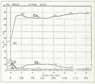
Fig. 11. — Cu dans HCl pendant 2 h.; analyse Auger en profondeur.
