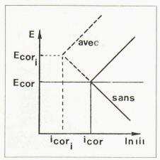
Fig. 1. — Inhibiteur anodique.
