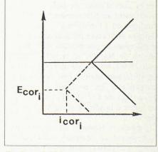
Fig. 3. — Inhibiteur mixte.
