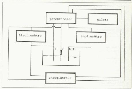
Fig. 6. — Schéma du montage électrochimique.
