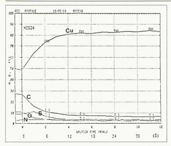
Fig. 10. — Cu dans H<sub>2</sub>SO<sub>4</sub> pendant 2 h.; analyse Auger en profondeur.
