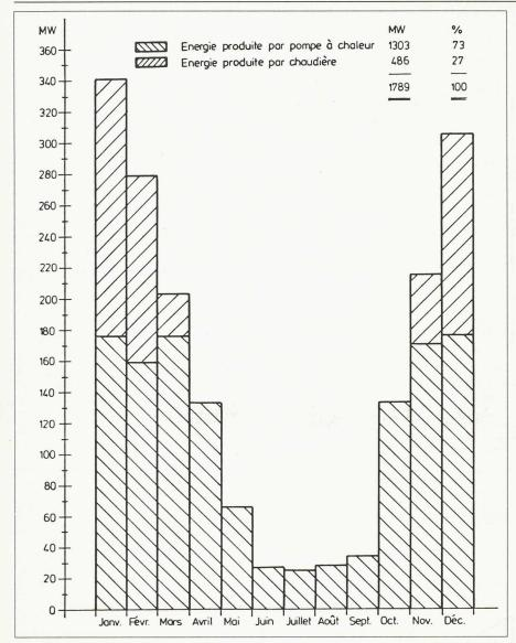
Fig. 5. — Couverture des besoins par la pompe à chaleur.
