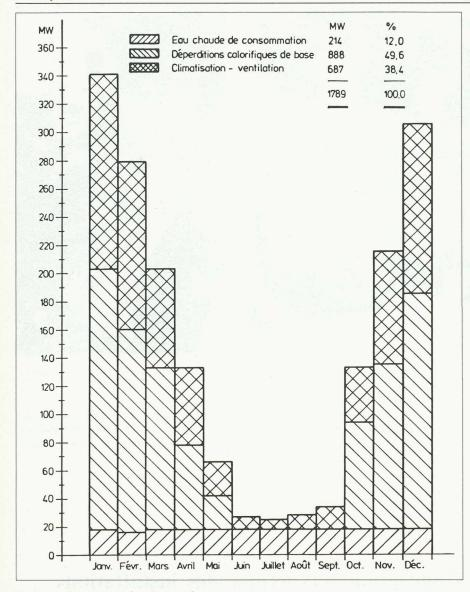
Fig. 1. — Besoin annuel en énergie thermique.
