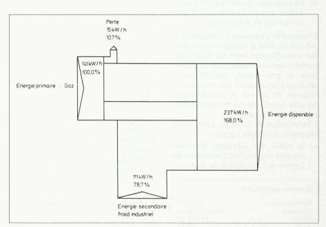
Fig. 2. — Diagramme d'énergie de la pompe à chaleur à gaz.
