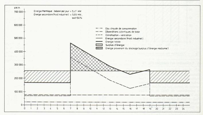
Fig. 4. — Besoins en énergie: emmagasinage de la chaleur produite la nuit. Température moyenne (mars): +4°C.
