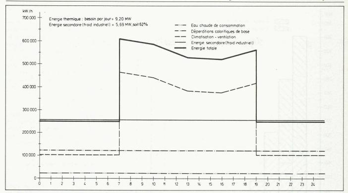
Fig. 3. — Besoins en énergie thermique du bâtiment. Température moyenne (janvier): -1,5 °C.
