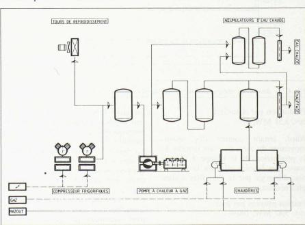
Fig. 6. — Schéma hydraulique de l'installation de chauffage.
