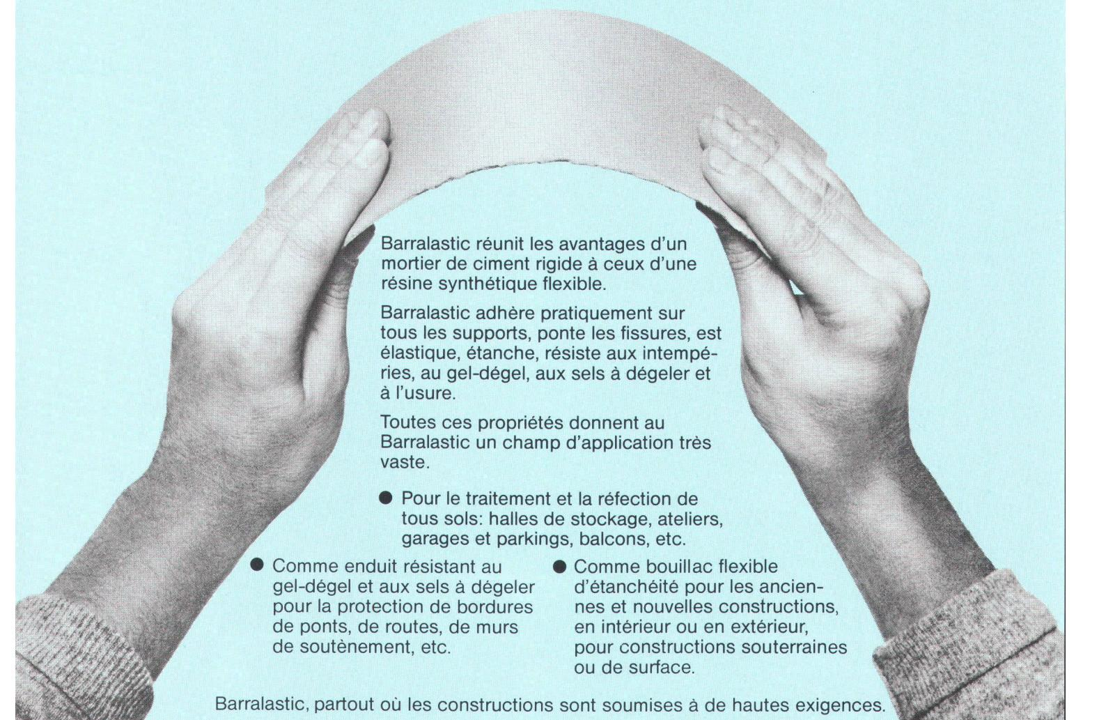
Barralastic réunit les avantages d'un mortier de ciment rigide à ceux d'une résine synthétique flexible.
