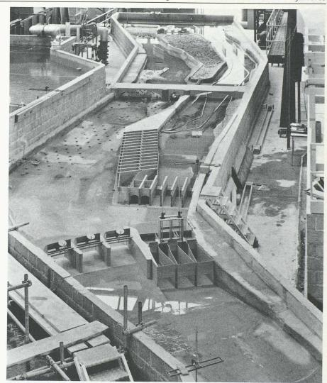
De la recherche... (Essais sur modèle pour le futur barrage de régulation du Léman, à Genève; variante comportant une centrale électrique, EPFL.)
