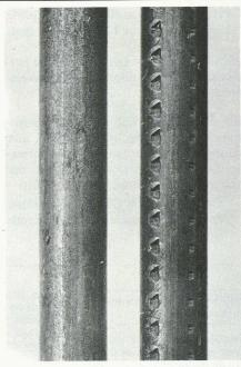
Fig. 1. — (Voir tableau I). Fils d'acier  $\emptyset$  5,8 mm à gauche lisse, à droite pourvu de petites empreintes.
