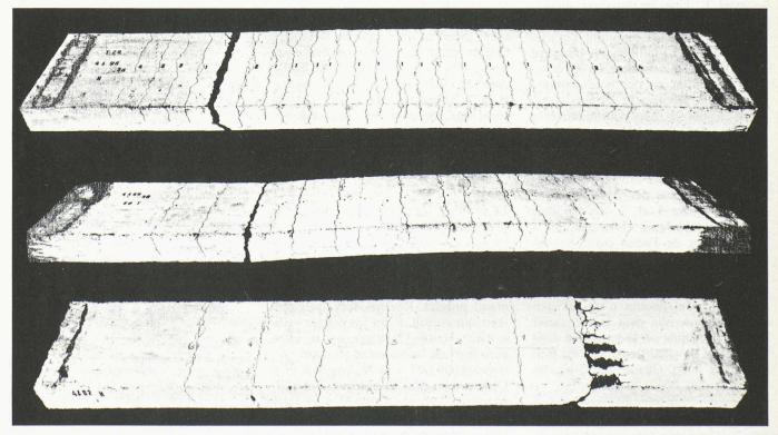
Etats de fissuration et de rupture des bandes de dalle, essais 1, 2 et 3.
