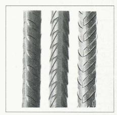
Fig. 4. — Fils d'acier profilés des treillis d'armature suisses.
