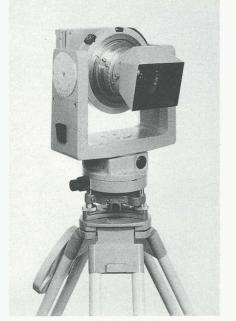
Fig. 2. — Camera fotografica Wild P31 f = 100 mm — dimensioni delle fotografie  $10 \times 12 \text{ cm}$ .
