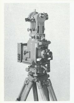
Fig. 1. — Fototeodolite Wild P30 f = 165 mm — dimensioni delle fotografie  $10 \times 15$  cm.
