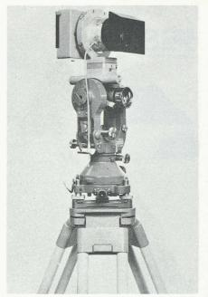
Fig. 3. — Fototeodolite Wild P32 f = 64 mm — dimensioni delle fotografie  $6 \times 8$  cm.
