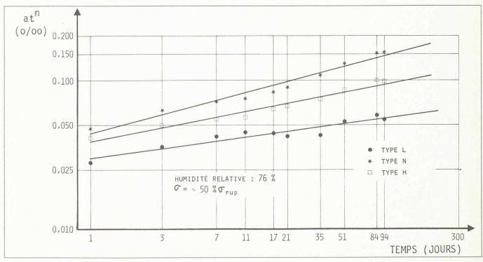
Fig. 7. — Valeurs du fluage reprises de la figure 6 et représentées à une échelle doublement logarithmique.
