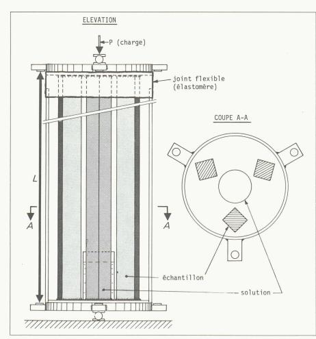
Fig. 1. — Montage expérimental pour les mesures de fluage.
