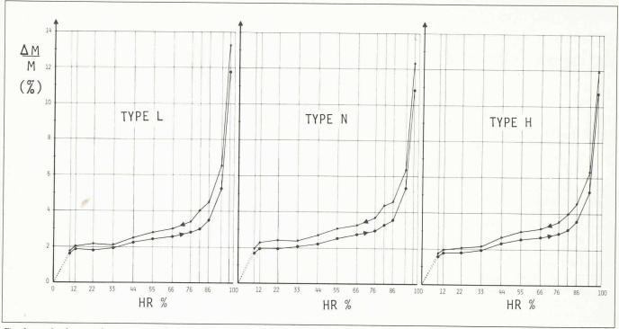
Fig. 2. — Isothermes de sorption pour trois types différents de béton cellulaire. Les courbes d'adsorption et de désorption sont indiquées par une flèche. Sur l'axe vertical, la variation de masse  $\frac{\Delta M}{M}$  (%) est indiquée.
