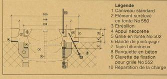
Fig. 2. — La conception permet une répartition optimale des charges.
