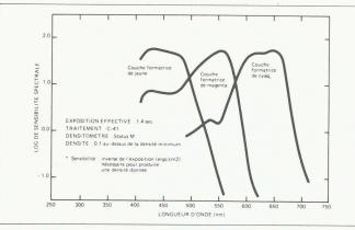
Fig. 5. — Courbes de sensibilité spectrale: les courbes de sensibilité spectrale décrivent la réponse de chaque couche formatrice de colorants à l'énergie de rayonnement des différentes longueurs d'onde. Les sensibilités relativement étendues des couches formatrices de colorants dans le film Kodacolor VR 1000 permettent de donner de bons résultats avec différents types de lumière, sans filtre spécial.
