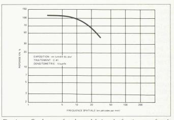
Fig. 4. — Courbe transfert de modulation: la fonction transfert de modulation du film représente la capacité du film à enregistrer avec précision des signaux de différentes fréquences spatiales. Une réponse de 100% signifie que le signal de sortie du film (la variation de densité) contient toutes les informations du signal d'entrée.
