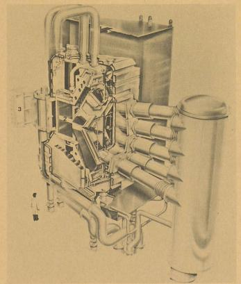
Chambre neutre d'injection du JET Tokamak. 1 Piège à ions à pleine énergie; 2 Calorimètre; 3 Ecrans de protection du tunnel.
