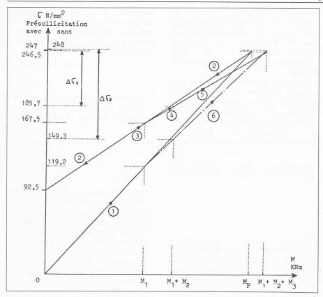
Fig. 2. — Evolution des contraintes dans la poutre préfléchie.
