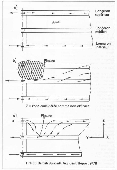
Fig. 8. — De l'importance du bien-fondé des hypothèses utilisées pour la conception Fail Safe: l'empennage ci-dessus s'est rompu en vol.
