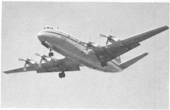
Fig. 5 — Danger de la conception Safe Life: un avion du type Vickers Viscount a été victime d'une rupture d'aile, à fin 1968. De légers défauts de fabrication d'un élément de longeron ont raccourci considérablement la durée de vie effective de cette pièce. (Photo J.-P. Weibel)
