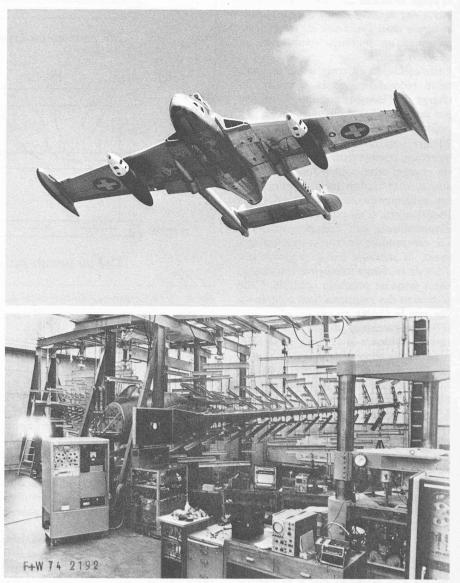
Fig. 7. — La simulation au sol, à un rythme accéléré, des charges agissant en vol sur un avion exige une installation complexe. Le simulateur de fatigue de la Fabrique fédérale d'avions d'Emmen permet de tenir compte de charges aussi complexes que celles résultant du largage des réservoirs, de la consommation de combustible ou survenant lors de l'atterrissage d'un DH-112 Venom (en haut). (Photos F + W Emmen)
