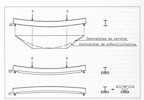
Fig. 1. — Principe de la poutre préfléchie.
