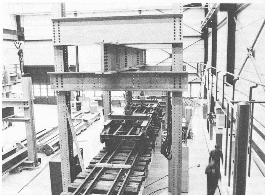
Fig. 6. — Essai en fatigue sur un pont-rail en vraie grandeur avec simulation des charges réelles, effectué à l'EPFL par les spécialistes de l'ICOM. Un bogie de wagon à voie étroite sert à l'introduction des charges. (Photo ICOM)
