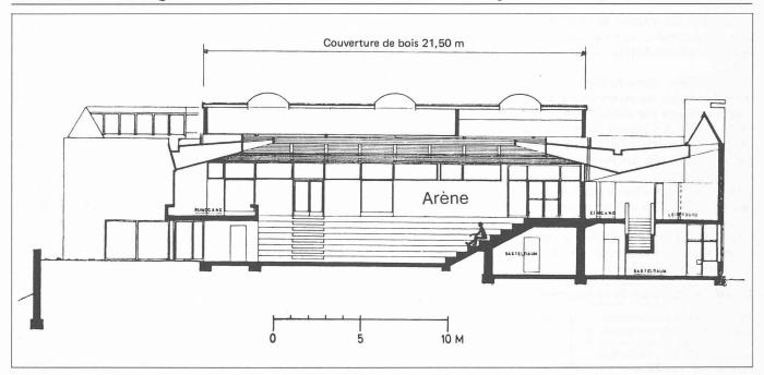
Coupe en travers de l'amphithéâtre. — Ce croquis met en évidence la solution élégante retenue pour la couverture de l'arène. Les quatre sommiers principaux en bois lamellé-collé n'enjambent que les deux tiers de la portée libre de 21,50 m. Pour cela, les architectes ont choisi une structure en forme de tourniquet, sans appuis au centre, mais qui repose sur les bâtiments entourant l'arène.
