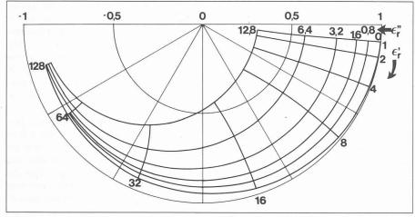
Fig. 8. — Diagramme polaire du facteur de réflexion d'un guide coaxial de type SR7 à 3 GHz en fonction de la permittivité relative complexe  $\varepsilon_r = \varepsilon_r' - j\varepsilon_r''$  du matériau placé devant l'ouverture du guide.
