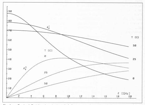
Fig. 1. — Partie réelle  $(\varepsilon'_r)$  et imaginaire  $(\varepsilon''_r)$  de la permittivité complexe de l'eau en fonction de la fréquence et de la température.
