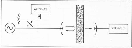
Fig. 2. — Dispositif de mesure en transmission.
