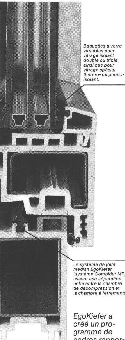
Le système de joint médian EgoKiefer (système Combidur MP) assure une séparation nette entre la chambre de décompression et la chambre à fermetures.
