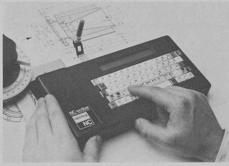
Le rotring NC-scriber est adaptable sur les raccords de règle du bouton de réglage d'une machine à dessiner.
