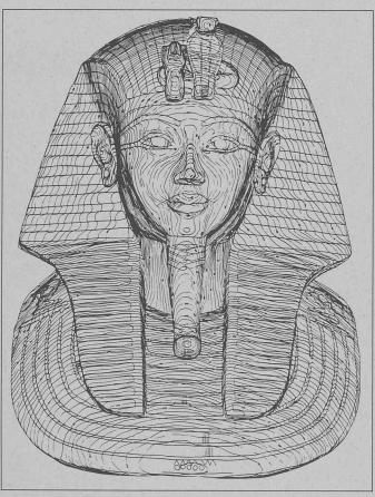
1) Le plan photogrammétrique ne donne pas seulement l'indication des surfaces en deux dimensions, il contient aussi des courbes de niveau très fines qui indiquent la troisième dimension comme dans une carte topographique — l'équidistance est de 1 mm. La restitution a été faite dans l'autographe Wild A10.
