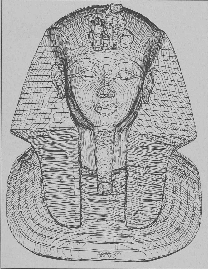
1) Le plan photogrammétrique ne donne pas seulement l'indication des surfaces en deux dimensions, il contient aussi des courbes de niveau très fines qui indiquent la troisième dimension comme dans une carte topographique — l'équidistance est de 1 mm. La restitution a été faite dans l'autographe Wild A10.
