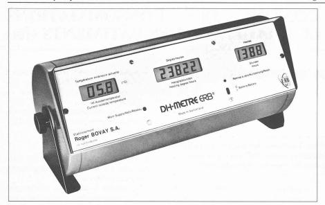
Fig. 3. — Thermomètre-intégrateur: DH-METRE ERB.
