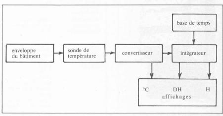
Fig. 2. — Chaîne de mesure pour la température extérieure.
