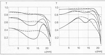
Fig. 7. — Exemple de diagrammes MTF pour l'objectif Carl Zeiss Tessar T\* 2,8/45 mm, pour deux ouvertures de diaphragme: 2,8 (à gauche) et 5,6 (à droite). Les trois groupes de courbes correspondent à des fréquences de 10, 20 et 40 lignes/mm. Les lignes pointillées indiquent que la trame est orientée tangentiellement, radialement pour les lignes pleines.
