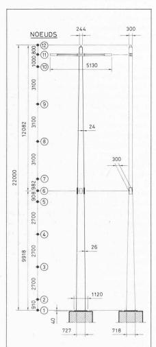
Fig. 1. — Géométrie du mât et position des nœuds du modèle numérique.
