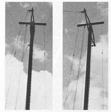
Fig. 2. — Essai de torsion: mât non chargé à gauche et chargé à droite.
