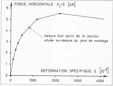
Fig. 6. — Allure de la courbe  $H_L/2 - \varepsilon$  de l'essai jusqu'à la ruine du mât porteur.
