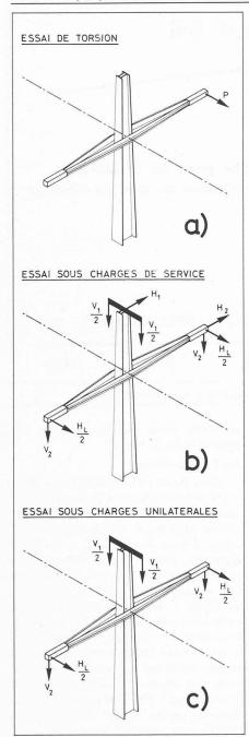
Fig. 3. — Schémas de charge.
