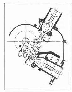
Fig. 1. — Système roue Pelton injecteurs [4].
