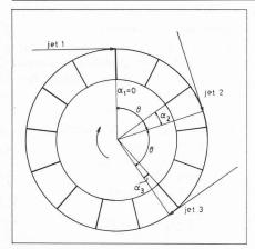
Fig. 3. — Représentation des déphasages  $\alpha_j$  sur un schéma d'une roue Pelton à 3 jets.
