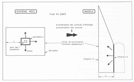
Fig. 2. — Schéma de la transformation pour la zone pérphérique du stock.
