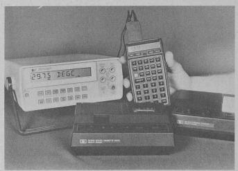
L'ordinateur de poche HP-41 peut désormais commander divers instruments de mesure, de nouveaux périphériques ainsi que des appareils d'autres fabricants, grâce à l'interface HP-IL.
