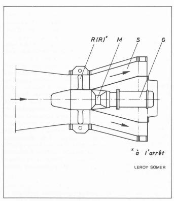
Fig. 6. — Turbine bulbe de série avec réglage par dissipation d'énergie dans un frein à induction (Neyrpic)
