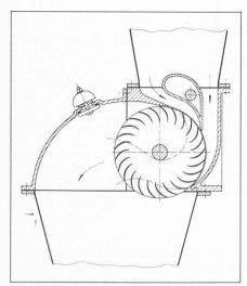
Fig. 8. — Turbine á flux traversant de la firme Ossberger, avec enveloppe des lignes de courant réelles.
