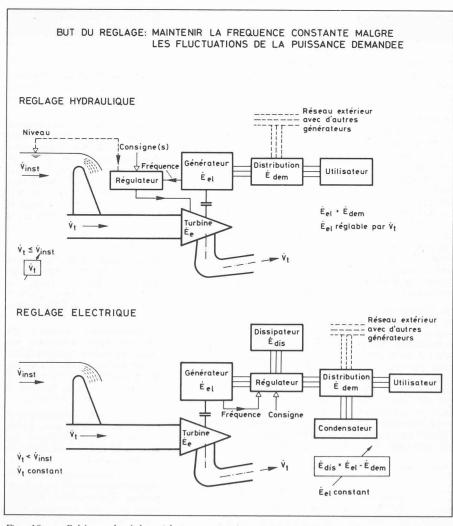
Fig. 10. — Schémas de réglage (chute constante). Puissances et débits: définitions Turbine hydraulique débit de l'installation débit absorbé par la turbine puissance hydraulique puissance mécanique à l'accouplement
