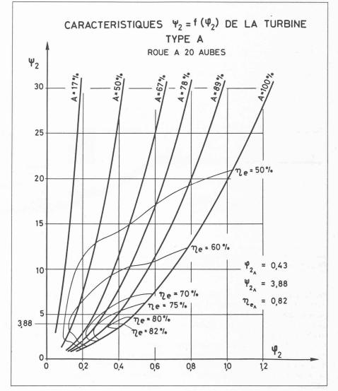
Fig. 9. — Caractéristiques de fonctionnement d'une turbine à flux traversant.
