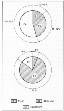
Fig. 1. — Comparaison des coûts d'une petite et d'une grande centrale à basse chute: A: Installation de petite puissance, 1,5 MW,
