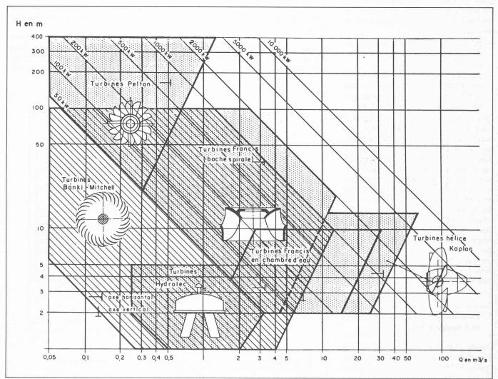
Fig. 2. — Possibilités d'équipement en turbines hydrauliques de faible puissance (d'après L. Monition, M. Le Nir et J. Roux: les micro-centrales hydroélectriques).
