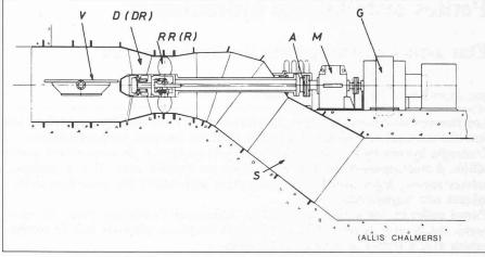
Fig. 3. — Turbine tubulaire — «S». Vanne D (DR) Distributeur fixe ou réglable
