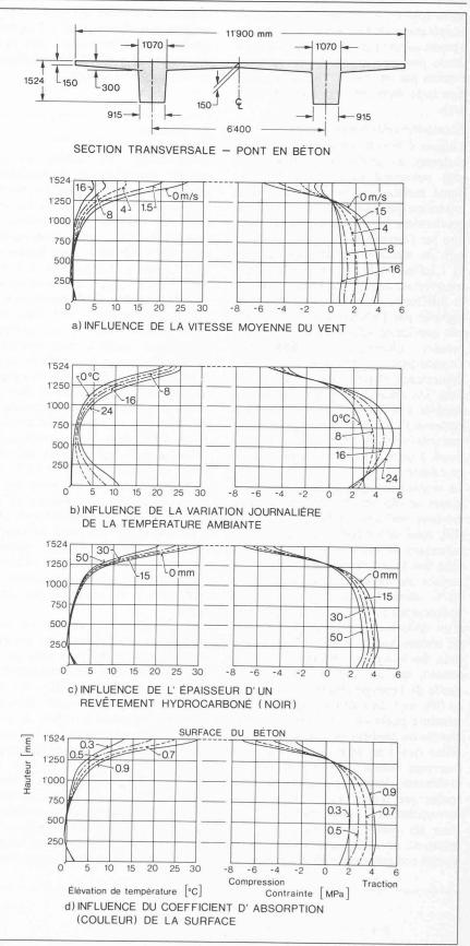
Fig. 6. — Etude paramétrique selon Priestley [12] et [19]: valeurs calculées pour la travée médiane d'un pont continu, situé en Nouvelle-Zélande, en été, sous un rayonnement solaire d'intensité 1100 W/m².
