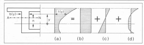
Fig. 10. — Décomposition d'une distribution de température:
