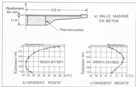
Fig. 2. — Exemple de distributions de température mesurées: Adur Bridge, Grande-Bretagne
