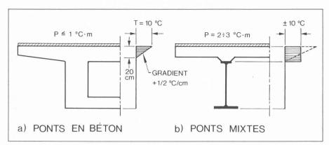
Fig. 7. — Gradients thermiques d'après la norme 160 (éd. 1970).
