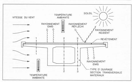
Fig. 1. — Paramètres influençant la réponse thermique.
