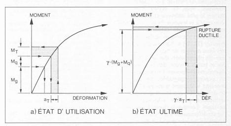
Fig. 14. — Signification des sollicitations thermiques aux états limites d'utilisation et ultime.
