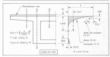
Fig. 9. — Gradients thermiques dans les ponts en béton selon le code néo-zélandais [18].
