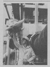
très chères et n'entrent pas en ligne de compte pour une surveillance efficace. En revanche, la méthode indirecte est économique. Elle consiste à mesurer et surveiller le rayonnement calorifique émis par l'enveloppe du four. Elle fournit au conducteur du four des indications précieuses sur l'état du revêtement réfractaire et sur la formation de collages à l'intérieur du four. Il peut ainsi déceler les défauts à un stade précoce et prendre les dispositions qui s'imposent.
