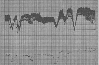
Enregistrement de la température d'un four rotatif. (Document Siemens)
