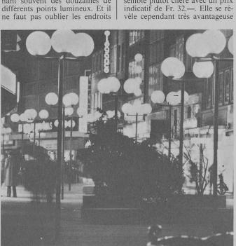
Des économies substantielles sont réalisées avec la mise en service de la lampe SL, particulièrement lorsqu'elle est utilisée en grand nombre et pour une longue durée d'enclenchement, comme par exemple pour l'éclairage d'une rue ou d'une place publique
