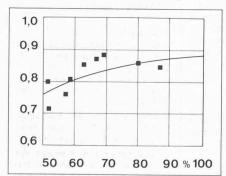
Fig. 2. — Rendement mesuré et préalablement calculé du récepteur. Rendement du récepteur (—). Puissance du récepteur (%). — Valeurs selon les calculs préalables.
