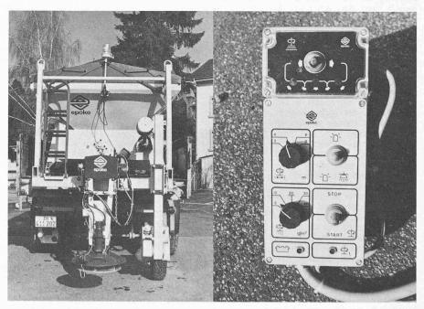
Fig. 1. — Véhicule à module d'épandage téléguidé.
