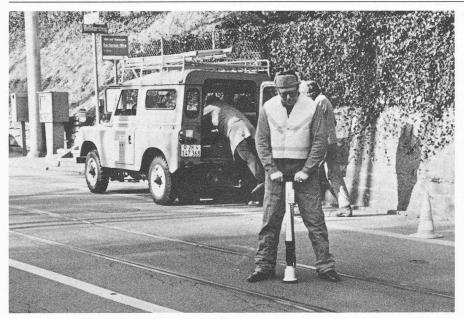
Fig. 4. — Appareil de mesure de contrôle de l'épandage de sel.
