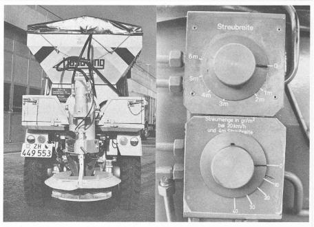
Fig. 2. — Véhicule à module d'épandage à réglage rotatif.
