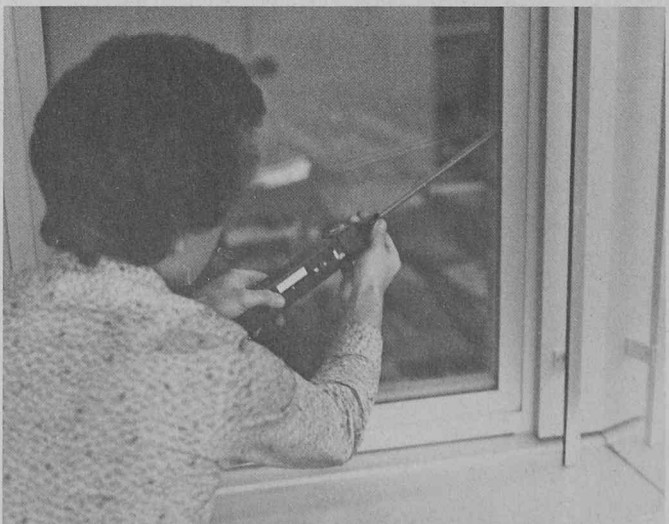
«Ultrapronic 108» détecte les fuites dans les joints, rainures et replis en toute fiabilité et rapidement. (Photo: Merz + Benteli SA)
