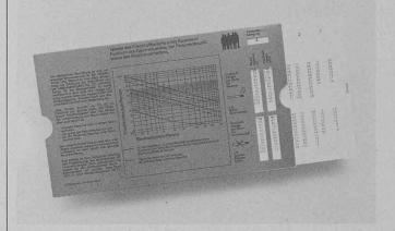
raisonnables pour une étude et d'établir un tableau de données reproduites sur une règle à calcul. Cet instrument de planification permet de déterminer de manière simple les besoins en air frais pour chaque local en fonction des personnes qui s'y trouvent et du volume de la pièce (pour fumeurs et non-fumeurs).
