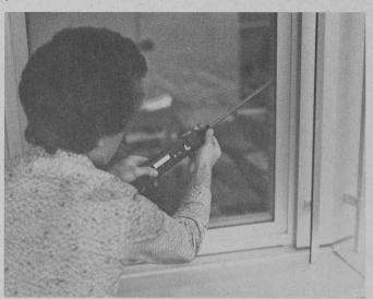
« Ultraphonic 108 » détecte les fuites dans les joints, rainures et replis en toute fiabilité et rapidement. (Photo: Merz + Benteli SA)
