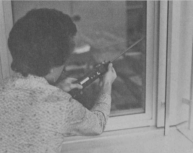
«Ultrapronic 108» détecte les fuites dans les joints, rainures et replis en toute fiabilité et rapidement.
