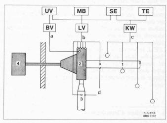
Disposition de mesure pour la détermination des sources de bruit aux pompes centrifuges.
