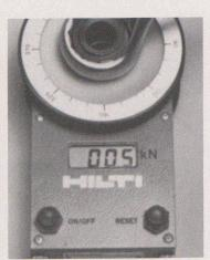
Et contrôler conformément à la pratique, la fixation exécutée à l'aide de l'appareil d'essais de chevilles.
