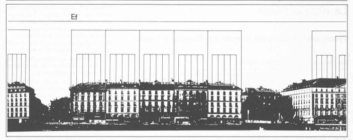
Fig. 2. — Elévation avec le diagramme d'ordonnancement (schéma modulaire).
