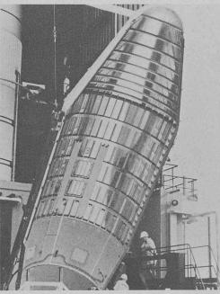
A la pointe de la technique spatiale, au propre comme au figuré: la coiffe de la fusée Ariane, construite par un consortium suisse sous la direction de Contraves SA, à Zurich, avec notamment la collaboration de la Fabrique fédérale d'avions d'Emmen. On voit ici le montage de la coiffe au Centre spatial de Kourou, en Guyane française.
