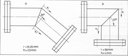
Fig. 5. — Géométrie des modèles de coudes cylindriques.
