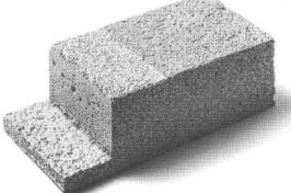
Il vous semblera naturel et normal qu'il ne se forme pas d'eau de condensation avec le système calorifuge <u>«rhodipor»</u> à base minérale, dont le pouvoir de respiration est semblable aux briques de terre cuite (μ6,8) et dont le lambda de calcul est de 0,056 W/mK. (Valeur de calcul selon Norm
