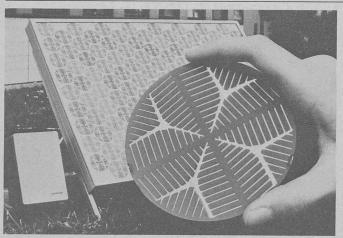
Ce nouveau module solaire (SM 144) de 120 watts comprend 144 disques de silicium monocristallin de 100 mm de diamètre chacun et existe en quatre versions pour des tensions nominales de 8, 16, 32 et 64 volts. Les courants de court-circuit respectifs sont de 16, 8, 4 et 2 ampères. Ses dimensions sont de 1 m  $\times$  1,46 m pour un poids de 27 kg.
