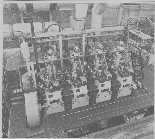
Moteur expérimental à quatre cylindres et balayage uniforme en cours de vérification et d'épreuves à l'appui, à
