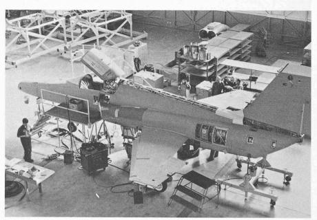
Montage final et contrôle d'un Tiger dans les ateliers de la F + W. La cellule reçoit ici divers équipements tels que radar, armement, radio, siège éjectable.
