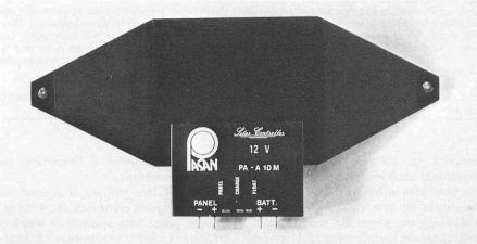
Fig. 5. — Régulateur. Caractéristiques techniques: 12 V Tension nominale 10 A Courant max. panneau Température de  $-10 \,\dot{a} + 40 \,^{\circ}C$ fonctionnement Tension max. à vide (entrée et sortie) 26 V 100 mA typ. 14,1 V +/- 0,3 V Courant de « Floating » Seuil de régulation Consommation sous 12 V entrée 20 mA max. Consommation «Standby» sur batterie 12 V 1 mA max.
