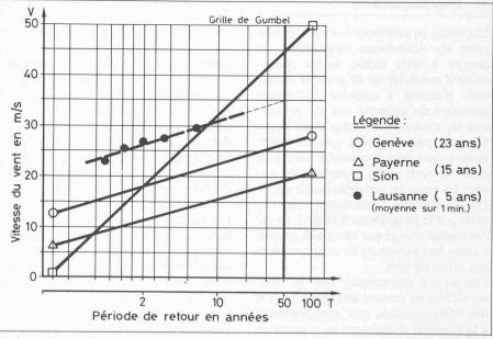
Fig. 5. — Vitesse du vent en fonction de la période de retour. Distribution des valeurs maximales annuelles (moyenne sur 10 min.).
