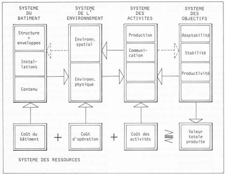
Fig. 2. — Modèle global du fonctionnement d'un bâtiment [6].
