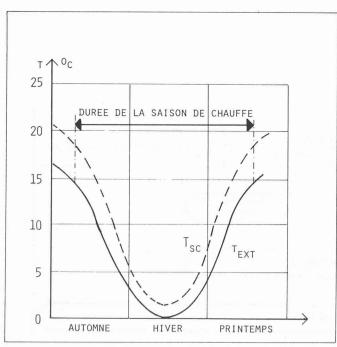
Fig. 5. — Température sans chauffage (tsc) [10].
