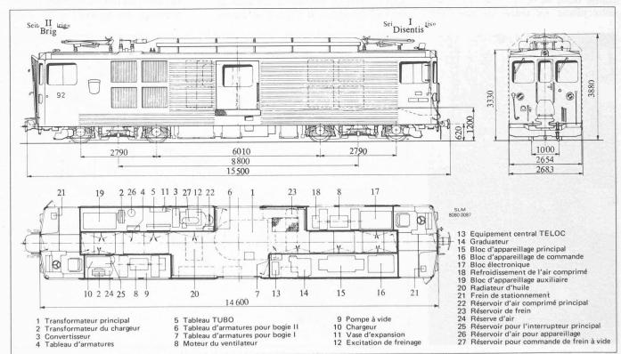
Fig. 2. — Plan-type du fourgon automoteur Deh 4/4 (nos 91-94).
