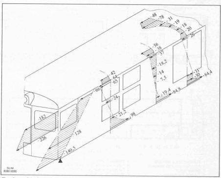
Fig. 5. — Résultats des mesures de contraintes (en N/mm²): paroi, cas de charge «remise sur rails».
