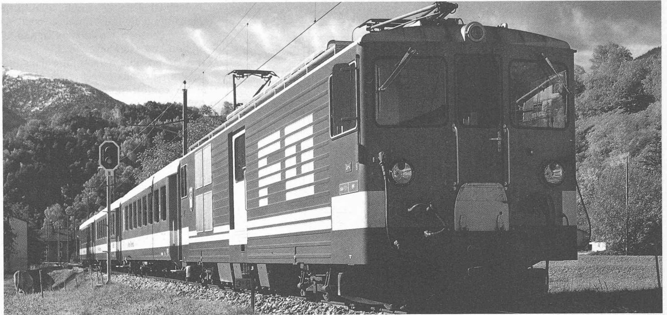
Fig. 1. — Fourgon automoteur Deh 4/4 II en tête d'une rame réversible.
