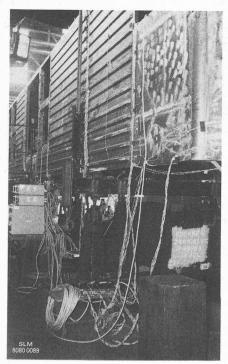
Fig. 4. — Mesures par jauges de contraintes sur la caisse brute.
