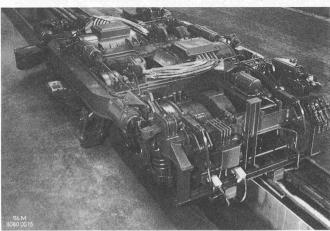
Fig. 8. — Bogie-moteur du fourgon automoteur Deh 4/411.
