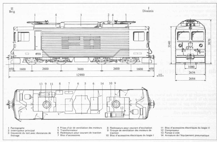
Fig. 3. — Plan-type des locomotives Ge 4/4<sup>111</sup> nos 81 et 82.
