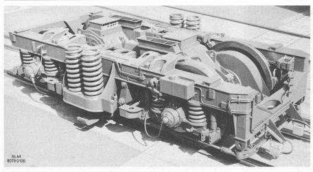
Fig. 4. — Bogie-moteur de locomotive Ge 4/4111.
