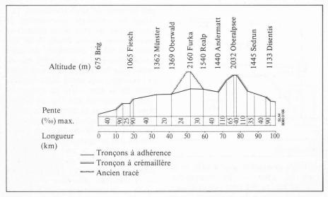
Fig. 1. — Profil en long de la ligne Brigue-Disentis.
